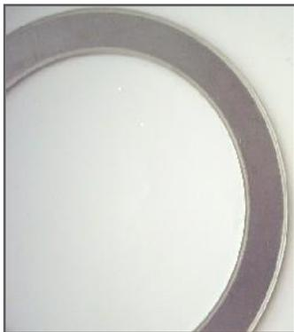
**Descrizione:**Guarnizione ricavate da foglio in grafite armata grattugia: ns. METAGRAPH G rinforzata con un bordino metallico interno, esterno o entrambi sp.0.10 mm. Per aumentarne le prestazione di tenuta. I bordini metallici, infatti impediscono l'erosione della guarnizione evitando l'infiltrazione tra lamina e grafite mantenendo così inalterate le proprietà meccaniche e una riduzione significativa delle emissioni fuggitive.
